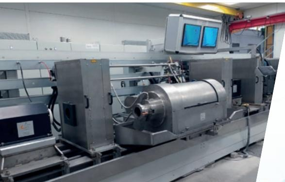
Les appareils de contrôle tels que les têtes tournantes (Courants de Foucault ou Ultrasons), les logiciels et les générateurs sont développés par CMS.
